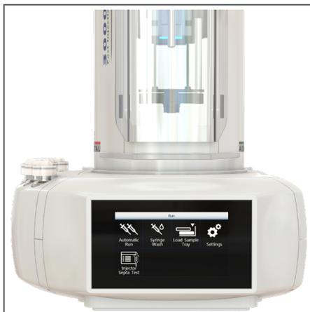
La **torre rotativa** deja libre el puerto del inyectador para **inyección manual o para operaciones de mantenimiento**. Además de evitar complicados procesos de transferencia de viales, este sistema **mantiene las muestras alejadas del horno del GC** para evitar la exposición a altas temperaturas, que podría degradar la muestra o provocar condensaciones en el vial.
